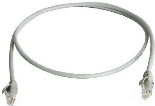
Tipo di cavo U/UTP, Categoria 6, Lunghezza 5 m, Tipo di connettore a innesto attacco 1 RJ45 8(8), Tipo di connettore a innesto attacco 2 RJ45 8(8), Colore rivestimento grigio, Involucro anti-piegia modellato, Protezione leva di arresto sì, Colore dell'involucro anti-piegia grigio, Versione antincendio sì, Privo di alogeni sì, Resistente all'olio secondo EN 60811-404 no, Assemblaggio cavi 4x2, Sezione AWG 24, Assegnazione pin 1:1
