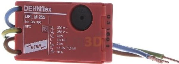
Tensione nominale CA 230 V, Massima tensione continua CA 255 V, Corrente di carico nominale 16 A, Corrente nominale di scarica (8/20) (L-N) 1,5 kA, Corrente di scarica totale (8/20) (L+N-PE) 3 kA, Livello di protezione L-N 1,25 kV, Livello di protezione L-PE/N-PE 1,5 kV, Numero di poli 2, Tipo di montaggio Incasso canale, Con contratto di telecomunicazione no, Segnalazione sul dispositivo acustico, Classe di prova tipo 3 si, Con filtro anti-interferenze no, Grado di protezione (IP) IP20
