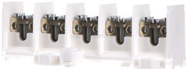
Numero di poli 5, Corrente nominale 80 A, Tipo di collegamento avvitare, Tipo di montaggio Vite, Numero di ingressi 5, Numero di uscite 10, Idoneo per conduttori massicci sì, Idoneo per conduttori multifilo sì, Sezione conduttore entrata 1,5..25 mm<sup>2</sup>, Sezione conduttore uscita 1,5..16 mm<sup>2</sup>, Sicuro al tatto no, Altezza 62 mm, Larghezza 197 mm, Profondità 49 mm
