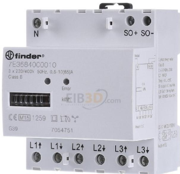
**Compteur triphasé 3Ph. calibré 3x10 (65A) - Compteur direct de kilowatt-heure 10A 7E.36.8.400.0010**
