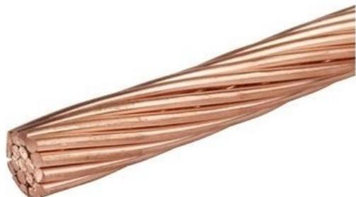
Section transversale 50 mm<sup>2</sup>, Diamètre extérieur 9 mm, Nombre de fils isolés 19, Diamètre des fils isolés 1,8 mm, Matériau Cuivre, Protection de surface non traité, Matériau de gainage sans, Poids 44 kg/100 m
