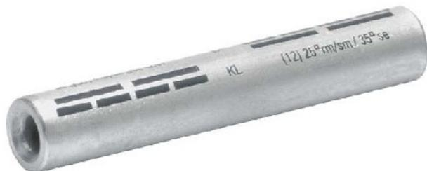
Forme de section rond/forme de secteur, Section nominale aluminium, RM/SM 150 mm<sup>2</sup>, Section nominale Al. réduite 70 mm<sup>2</sup>, Connexion comme boulon en Cu non, Matériau Aluminium, Pour raccords résistants à la traction non, Convient pour câble Al/St. oui, Convient pour câble Aldrey non, Arrêt d'huile / barre centrale non, Série de potentiels 12/20 kV
