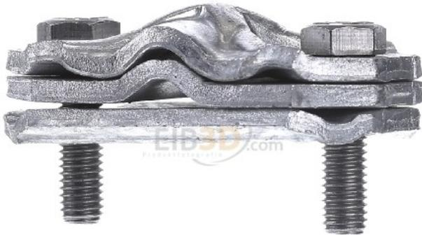
Verbindungs-/Trennklemme St/tZn f. Rd7-10 454 000 Rundleiterdurchmesser Leiter 1 5 ... 10mm, Flachleiterbreite Leiter 2 30 ... 40mm, Werkstoff Stahl, Oberfläche tauchfeuerverzinkt, Verbindungs- / Trennklemme nach DIN EN 62561-1, zum Verbinden der Ableitung mit den Erdeinführung. Ausführung dreiteilig (mit Zwischenplatte), für Rund- und Flachleiter (Breite bis 40 mm).
