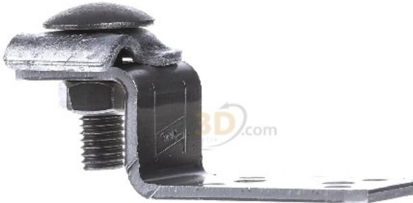
Anschlusslasche Z-Form Al Rd6-10 377 100 Art des Zubehörs Anschlusslasche, Werkstoff Aluminium, Oberfläche unbehandelt, Anschlusslasche nach DIN EN 62561-1, zum Anschließen von Metallverkleidungen durch Nieten oder Schrauben. Ausführung mit Klemmbock.
